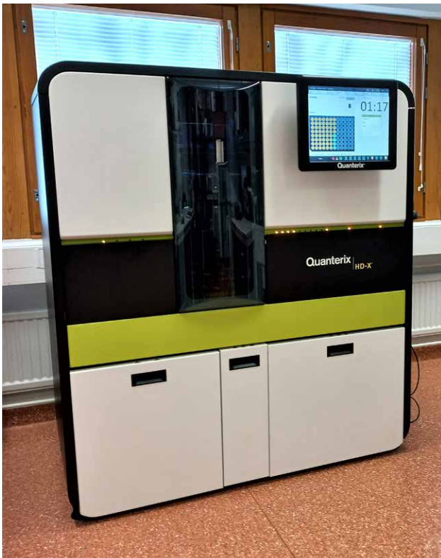
KUVA 2. Biomarkkerilaboratorion Simoa HD-X analysaattori
